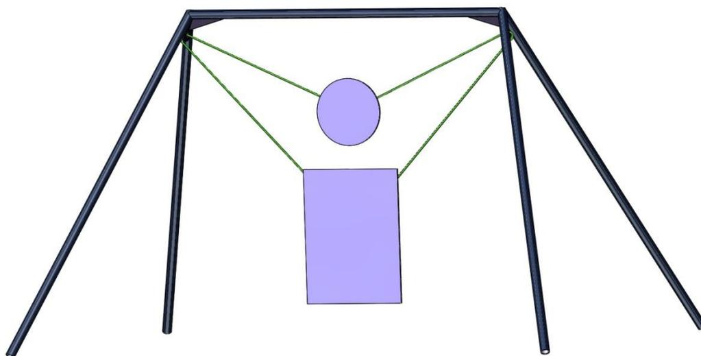
Металните мишени за дистанции до 300 метра е препоръчително да се изработват от ламарина с дебелина 16 или 20 мм, така мишените стават сравнително тежки и няма да се превъртат и преобръщат при попадение.
